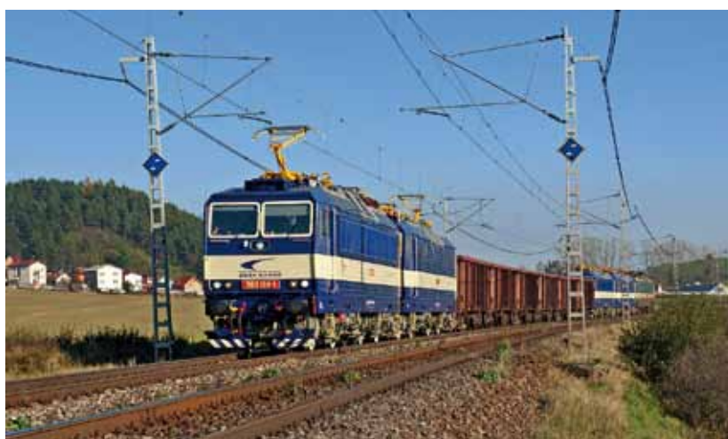
POPRVÉ. Provozní zkoušky modernizovaných lokomotiv řady 363 ZSSK Cargo proběhly v říjnu 2014 mezi stanicemi Spišská Nová Ves – Svit. FOTO MARTIN PLÍHAL
