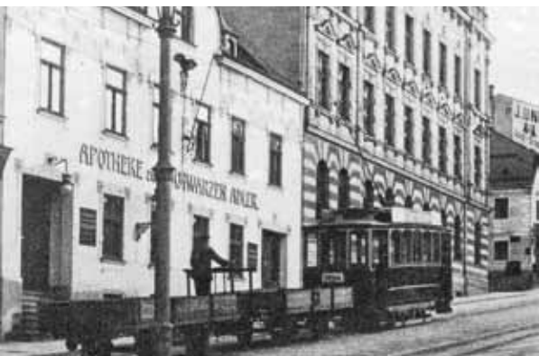
Tramvaj táhne prázdné nákladní vozy s brzdářem. Snímek pochází přibližně z roku 1913.
