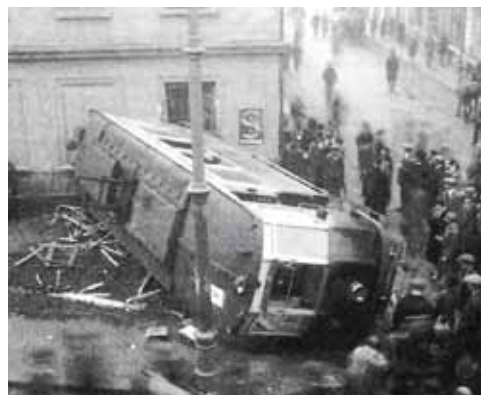
Takto si lehla tramvaj na dolním konci kritického úseku 5. 5. 1927, když jí selhaly brzdy. Foto: DP (3x)
