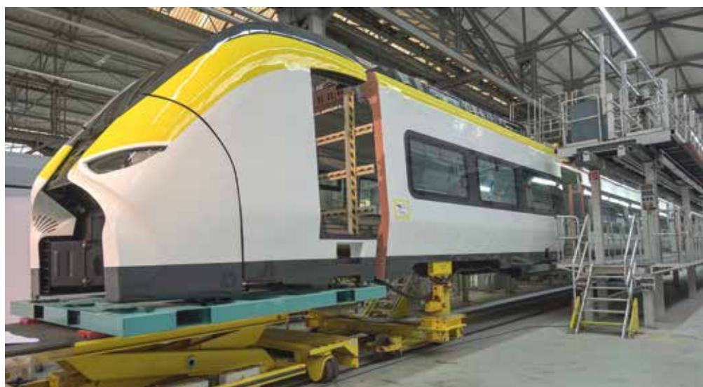
Veškeré technické komponenty jsou instalovány buď pod podlahou, nebo na střeše. Díky tomu lze každý centimetr vnitřního prostoru využít ke zvýšení pohodlí cestujících
