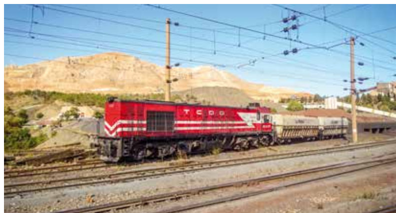
Mohutný diesellový stroj řady DE24000 posunuje ve stanici Demirdağ. Lokomotivy této řady vyrobili ve Francii v letech 1970–1984.
