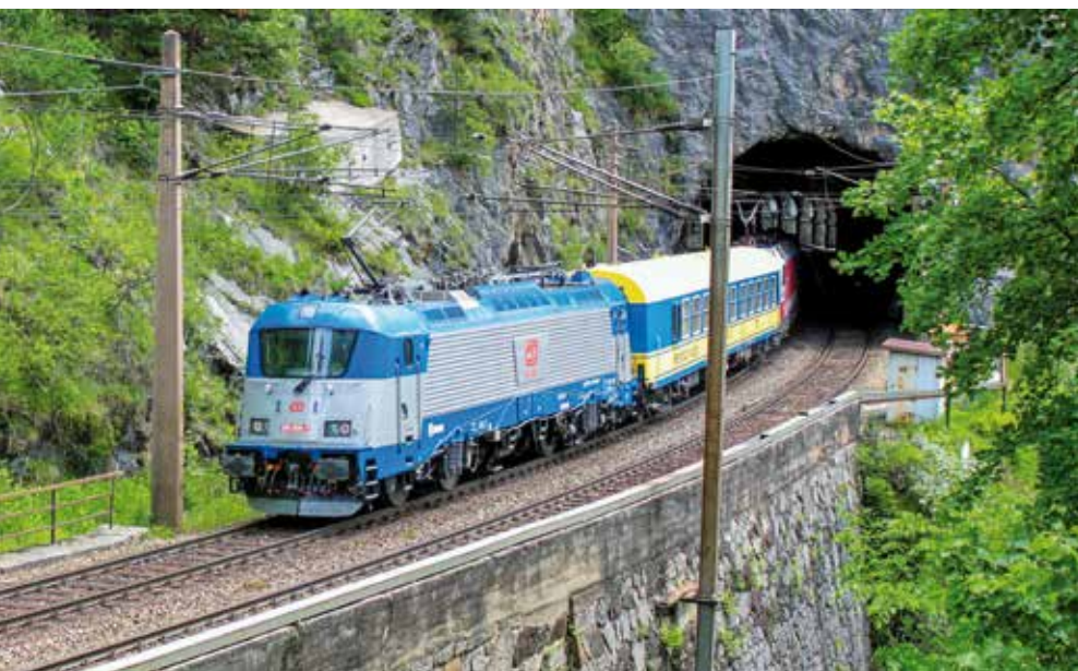
Lokomotiva ŠKODA 109E s měřícím vozem VÚKV při jízdně-technických zkouškách na horské trati přes Semmering v Rakousku
