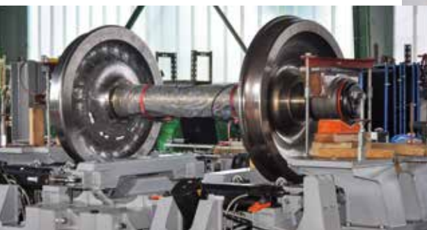
Kalibrační stav pro přípravu měřicích dvojkolí VÚKV čtvrté generace
