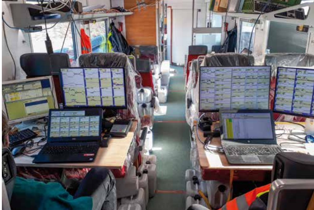
Řídicí pracoviště zkoušek jízdních vlastností se zpravidla nachází přímo v měřeném vozidle
