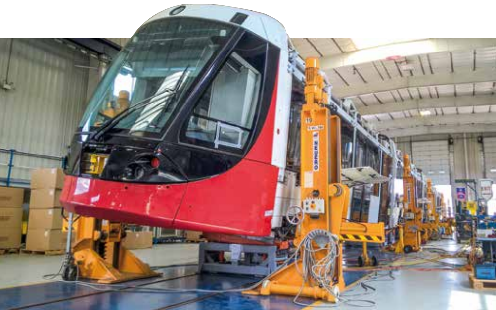
Měření náklonu a hodnot kolových sil z hlediska bezpečnosti proti vykolejení na tramvaji pro kanadskou Ottawu přímo ve výrobním závodě v USA
