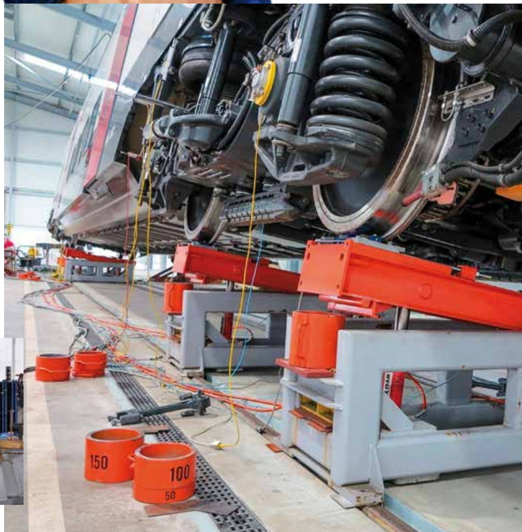
Mobilní zkušební stav VÚKV je univerzální stavebnicové zařízení, které se využívá i při dalších zkouškách. Na obrázku je zkouška náklonu patrového vozu při převýšení 250 mm
