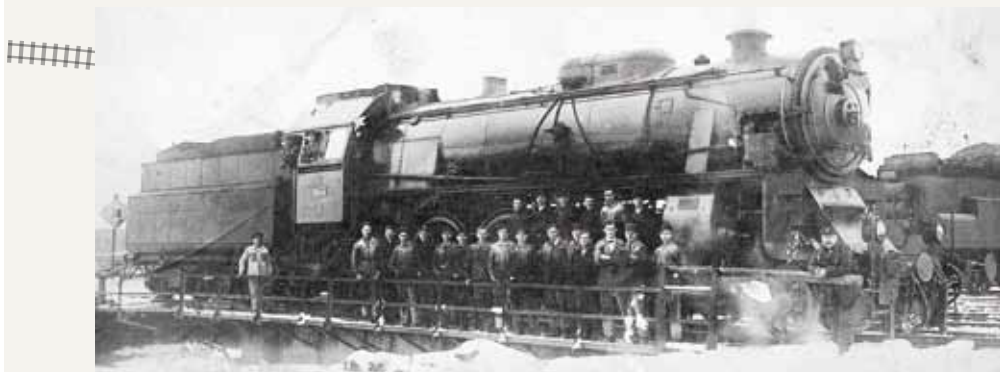
První vyrobené Mikádo ještě pod označením 386.001 a bez později typických usměrňovačů kouře
