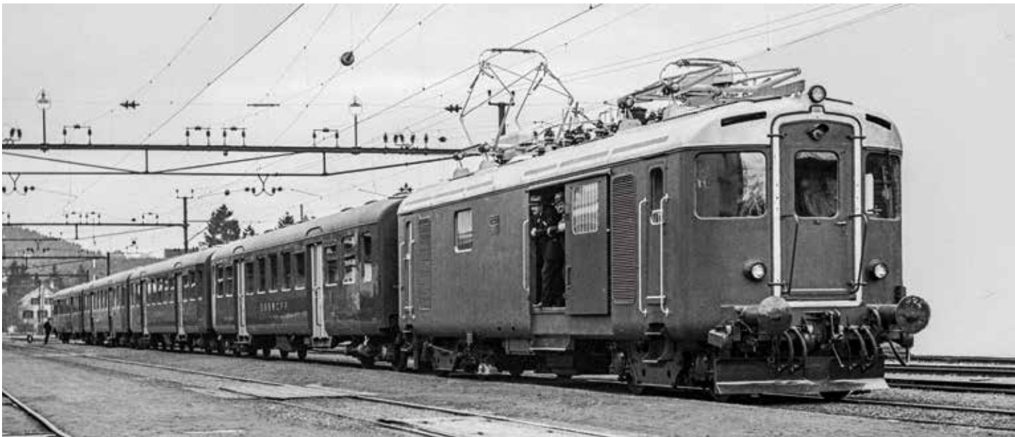
Předchůdcem lokomotiv Re 4/4 I byla trojice motorových vozů RFe 4/4, které se však neosvědčily pro svůj malý výkon. Vůz je v čele soupravy nových lehkých ocelových vozů, které SBB objednávala od konce 30. let. Jejich hmotnost byla jen okolo 28 tun
