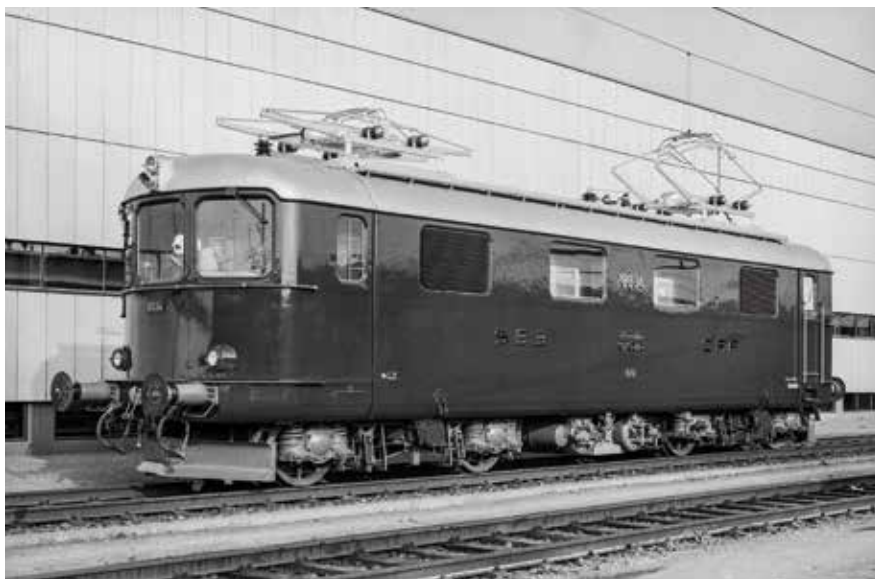
Druhá série lokomotiv Re 4/4 I už neměla na čele dveře pro průchod do soupravy a zmenšil se počet oken na boku
