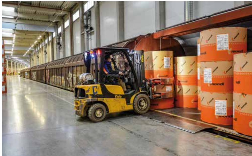
Vykládka papírových rolí z železničních vozů
