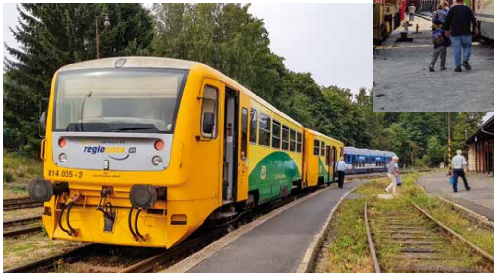
RegioNovy jsou patrně neúspěšnější modernizací řady 810, jejich největším benefitem je nízkopodlažní vstup. Vpravo nahoře vůz přestavěný na řadu 812, díky barvě se mu začalo přezdívat Esmeralda.
