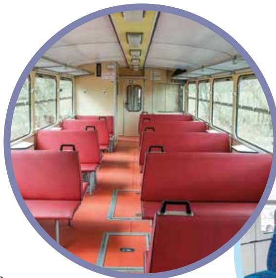
Z výroby měly motoráky 810 i jejich přívěsné vozy 010 nepříliš pohodlné lavice potažené koženkou. Prvotním modernizačním cílem tedy bylo nahradit je komfortnějšími sedadly.
