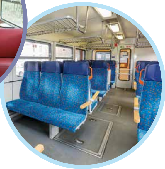
Z výroby měly motoráky 810 i jejich přívěsné vozy 010 nepříliš pohodlné lavice potažené koženkou. Prvotním modernizačním cílem tedy bylo nahradit je komfortnějšími sedadly.
