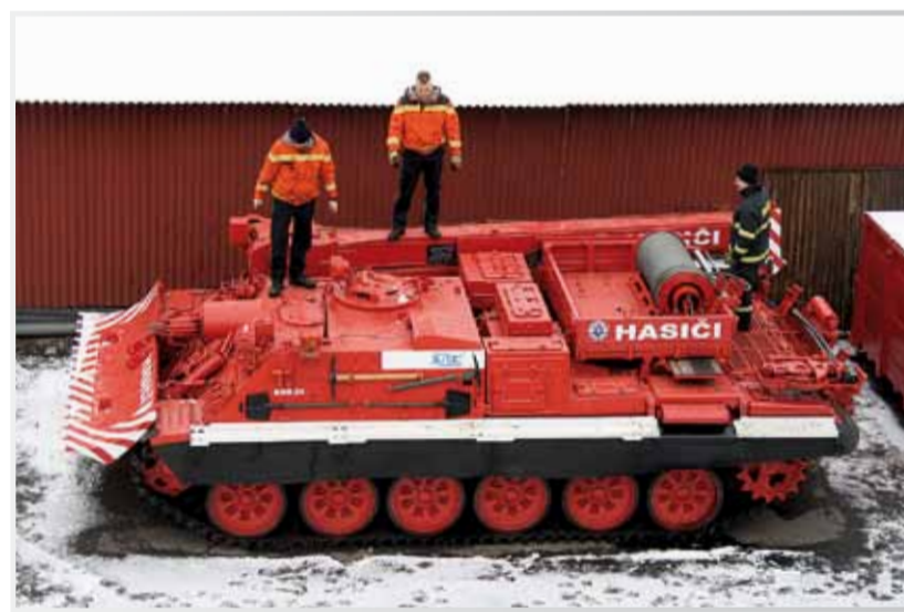
SILÁK. Vyprošťovacím tankem VT 72B lze dostat z kolejí i vůz o hmotnosti 90 tun.
