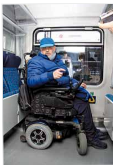
Odmontování dvou sedáků v oddílu uspoří asi 30 centimetrů prostoru.
