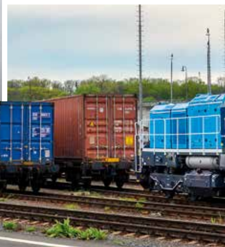
Z důvodu snížení hlučnosti nasazuje ČD Cargo na obsluhu přístavní vlečky v Mělníku modernizované lokomotivy řady 742.71
