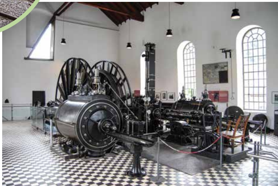
Velké stabilní parní stroje pomáhaly v dolech čerpat vodu i dopravovat horníky a vozíky do štola
