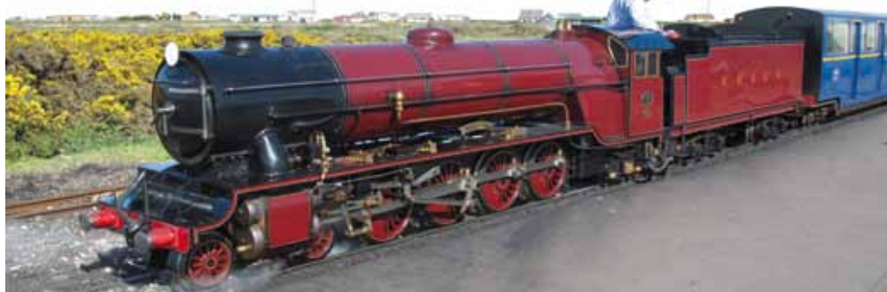
Lokomotiva Hercules, starší z jediných strojů s uspořádáním dvojkolí 2' D 1' v Británii v konečné stanici Dungeness
