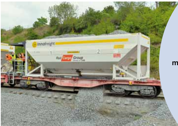
Zkušební vykládka šterku z nástaveb RockTainer INFRRA, které by v blízké budoucnosti mohly nahradit část starších výsypných vozů Faccs.
