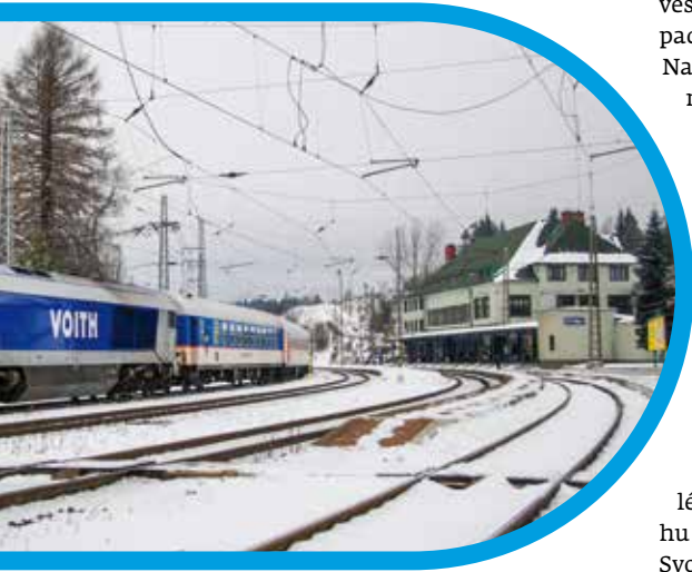
↑ Lokomotiva Voith Maxima 40 CC při trakčních zkouškách ve stanici Štrba
