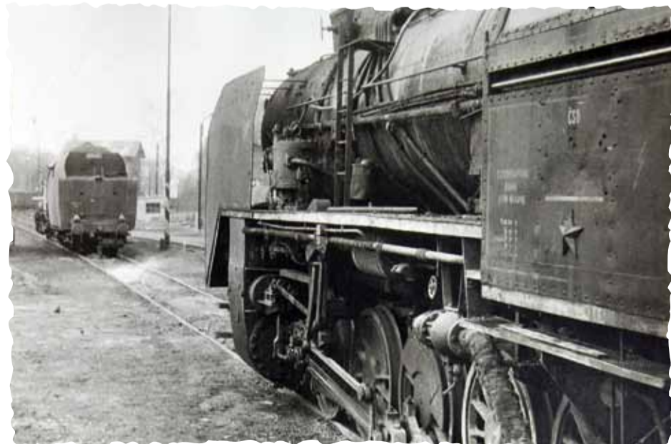
ZBROJENÍ. Vytápěcí kotle tvořené lokomotivami 556.0238 a 534.0323 pravidelně v určitém intervalu dobíraly uhlí a vodu. Zároveň u nich bylo prováděno vysypávání popelníku.
