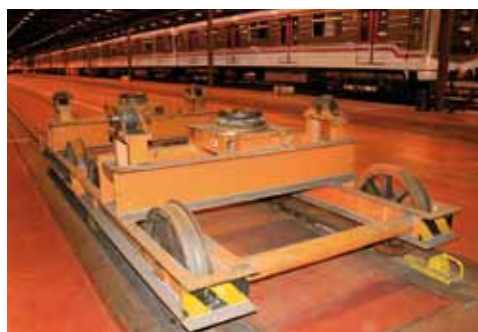
Během vyvazovacích oprav se skříň vozu ukládá na tyto „falešné“ podvozky.
