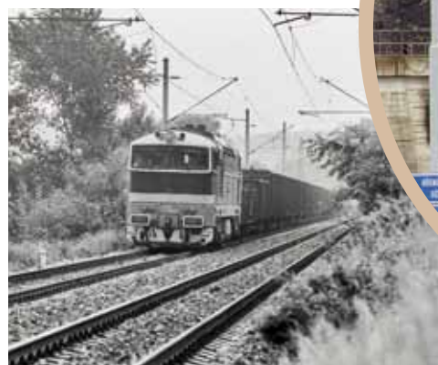
Jedním z předchůdců elektrické trakce byl například dnes již legendární stroj zvaný Brejlovec.
