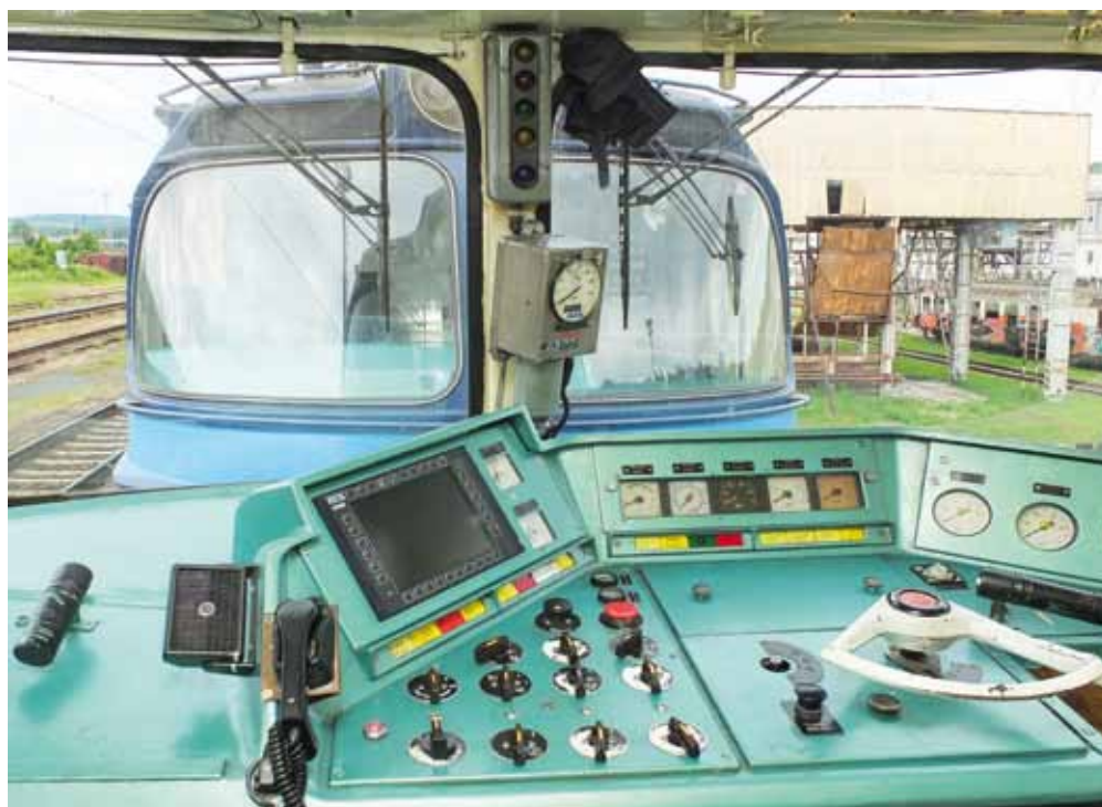
Pohled na stanoviště řady 230 s návěstním opakovačem LVZ, který je v meziokenním rámu nad rychloměrem.
