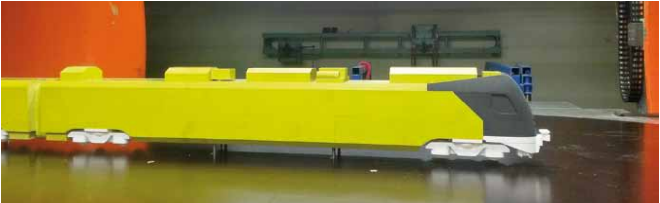
Pracovní model jednopodlažní elektrické jednotky Škoda při zkoušce v aerodynamickém tunelu, kterou provedli pracovníci VÚKV v těsné spolupráci s Výzkumným a zkušebním leteckým ústavem v Praze.
