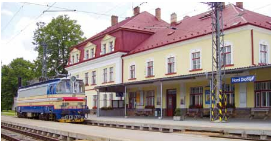
Vícesystémový stroj 340.055 byl nasazován na vozbu mezinárodních rychlíků i nákladních vlaků.
