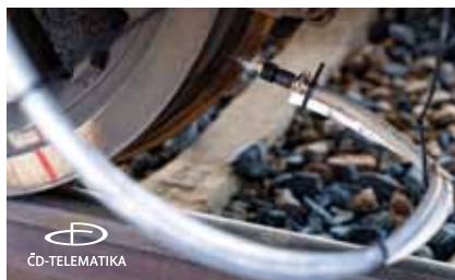
Aplikace speciálního mýdlového roztoku pro simulaci zhoršených adhezních podmínek
