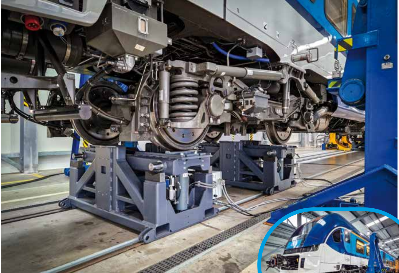
Měření minimální svislé kolové síly na jednotce PESA 847 pro ČD z počátku února tohoto roku
