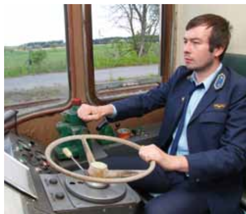
Stanoviště strojvedoucího v motorovém voze původní řady M 240.0 s typickým volantem kontroleru.
