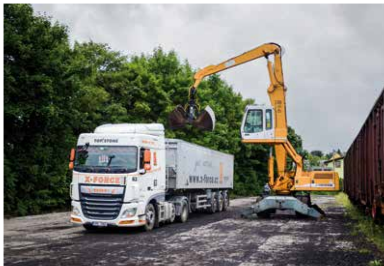
V areálu uhelných skladů v Šenově u Nového Jičína probíhá překládka tohoto paliva z železničních vozů přímo na nákladní automobily, které je rozvázejí k cílovým spotřebitelům
