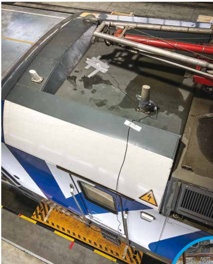
Testování systému ETCS na lokomotivě VUZ (Vectron)
