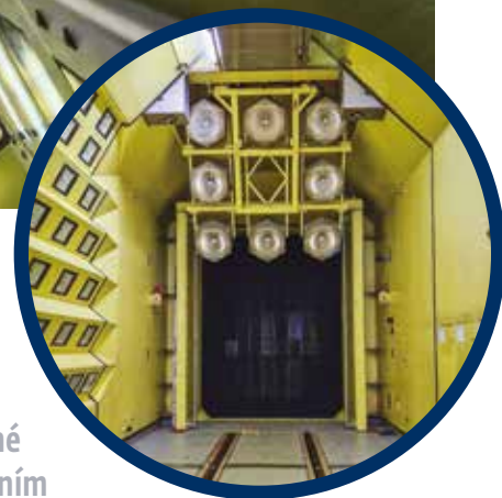
Restaurační vůz konzumuje v menší z komor RAC přímý letní násvit. Vpravo čelní lampy ve velké komoře.
