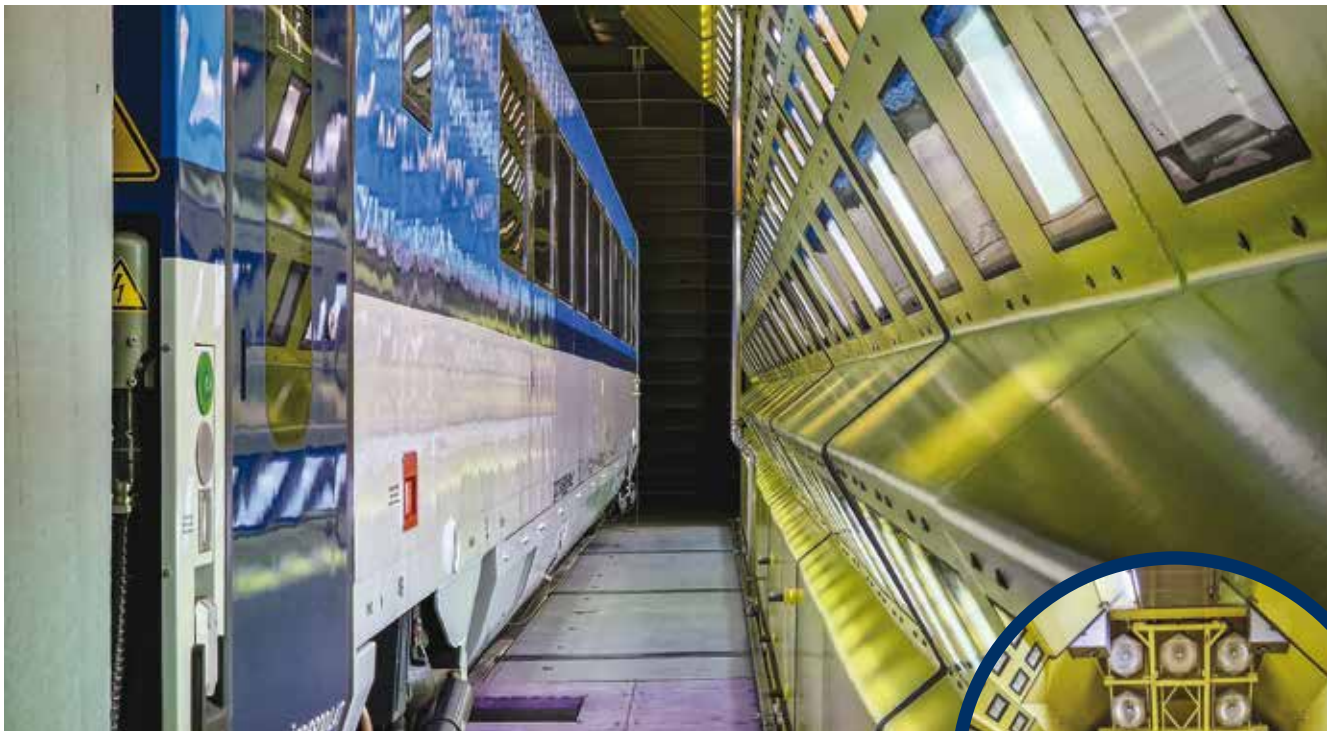
Restaurační vůz konzumuje v menší z komor RAC přímý letní násvit. Vpravo čelní lampy ve velké komoře.
