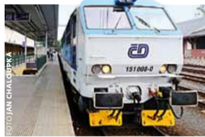
Hliníkové odlévané tabulky jsou nahrazovány již jen samolepkami.
