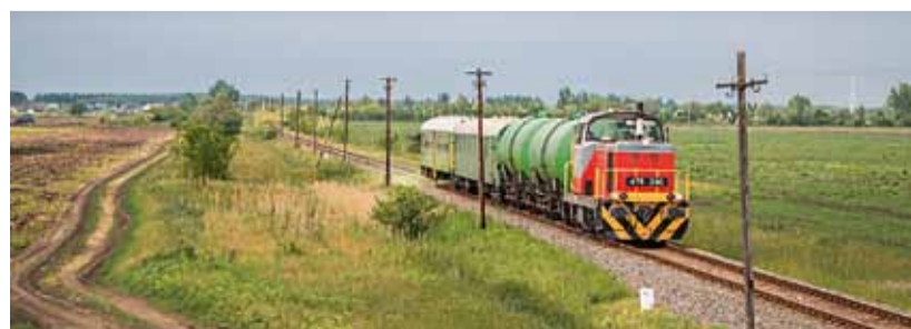
PLEVELOBIJEC. Soupravu tvoří cisternové vozy s pesticidy a vagony s rozstřikovací technologií. Dopravu často zajišťují malé motorové stroje. FOTO ATTILA VÖRÖS
