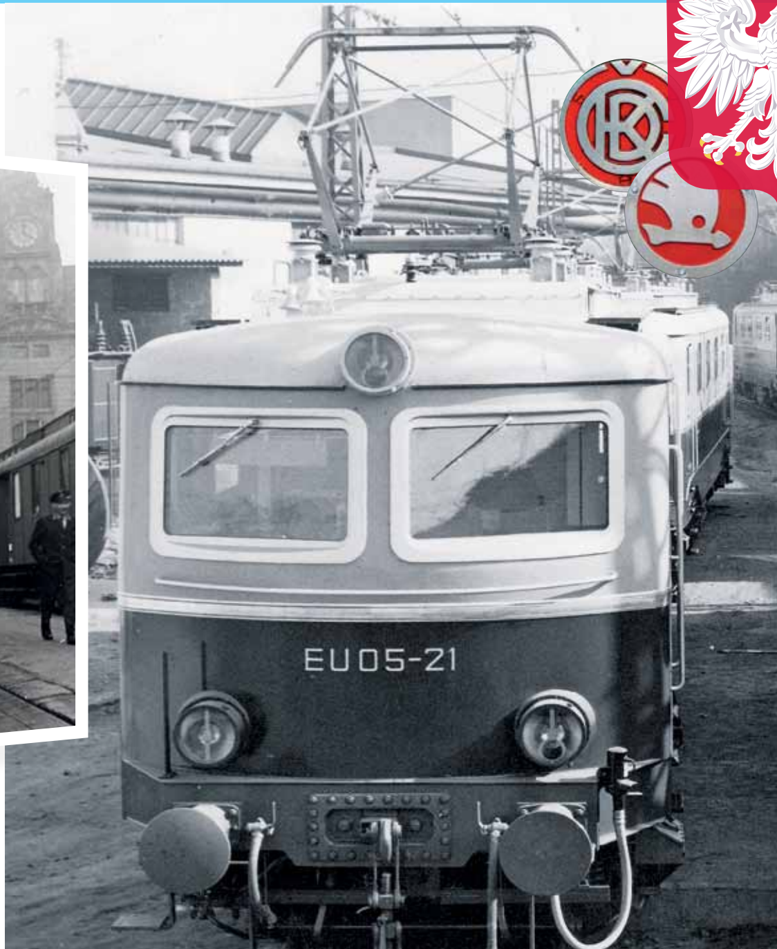
Flotila lokomotiv EU 05 krátce po svém dokončení ve strojárnách v Plzni. Stroje byly původně konstruovány pro maximální rychlost 125 km/h, rychlost zvýšila na 160 km/h, a staly se tak nejrychleji jezdícími Bobinami. Současně byly přeznačeny na řadu EP 05.
