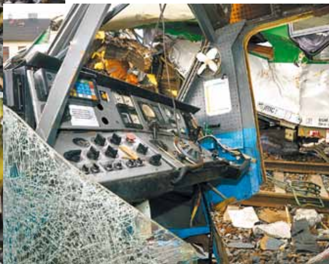
Stanoviště strojvedoucího a to, co z něj po nehodě zbylo.
