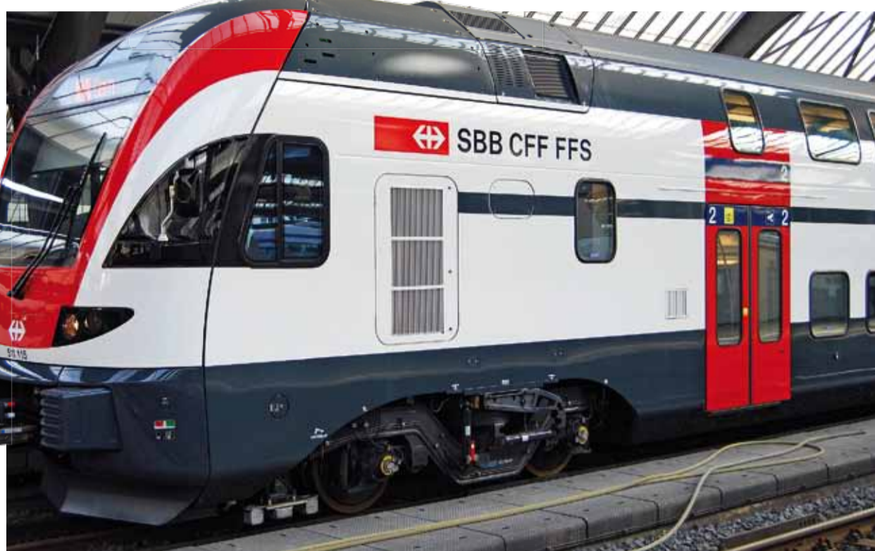
NOVINKA. Elektrické jednotky od firmy Stadler nosí u SBB označení RABe 511. Šestivozové vlaky disponují výkonem 4 MW a díky lehké konstrukci činí zrychlení 1,1 metru za sekundu. Maximální rychlost je pak 160 km/h. FOTO AUTOR (2x)
