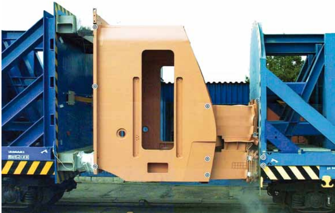
Zkoušku kolizní odolnosti kabiny strojvedoucího elektrické jednotky simulací střetu dvou identických jednotek pomocí nárazecího vozu provedli pracovníci společnosti VÚKV na svážném pahrbku VÚKV v Cerhenicích.
