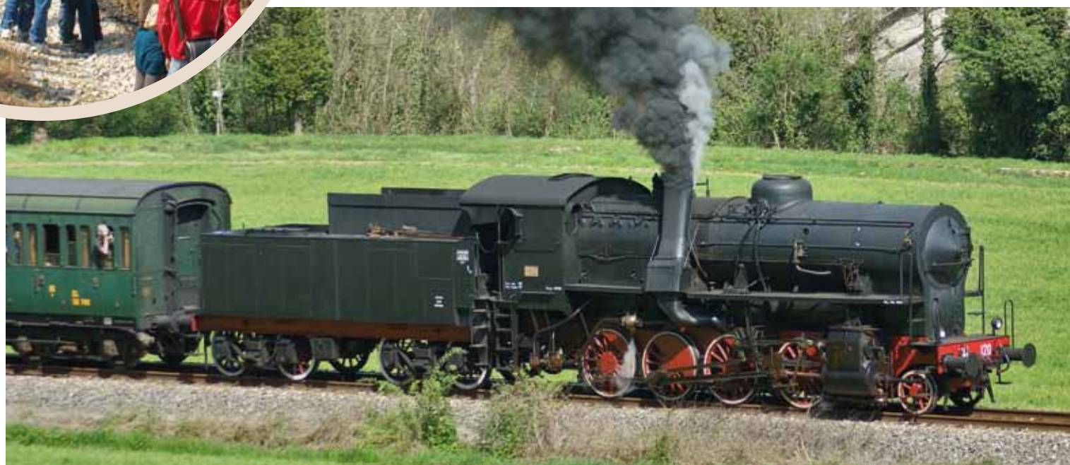
Provozní stroj 741.120 se speciálním kotlem Franco-Crosti je obzvláště bizarní.
