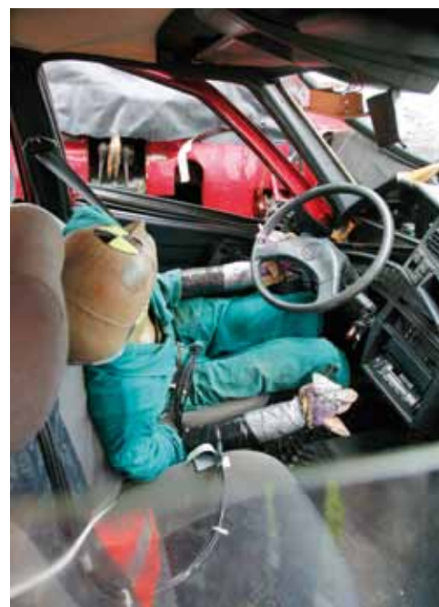
Simulační figurína po zkoušce nárazu vlaku do automobilu na přejezdu →
