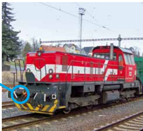
Lokomotivy řady 724.7 mají za nárazníkem umístěn deformační prvek, který je po vylepšení na základě výsledků numerických simulací provedených ve VÚKV chráněn průmyslovým vzorem.
