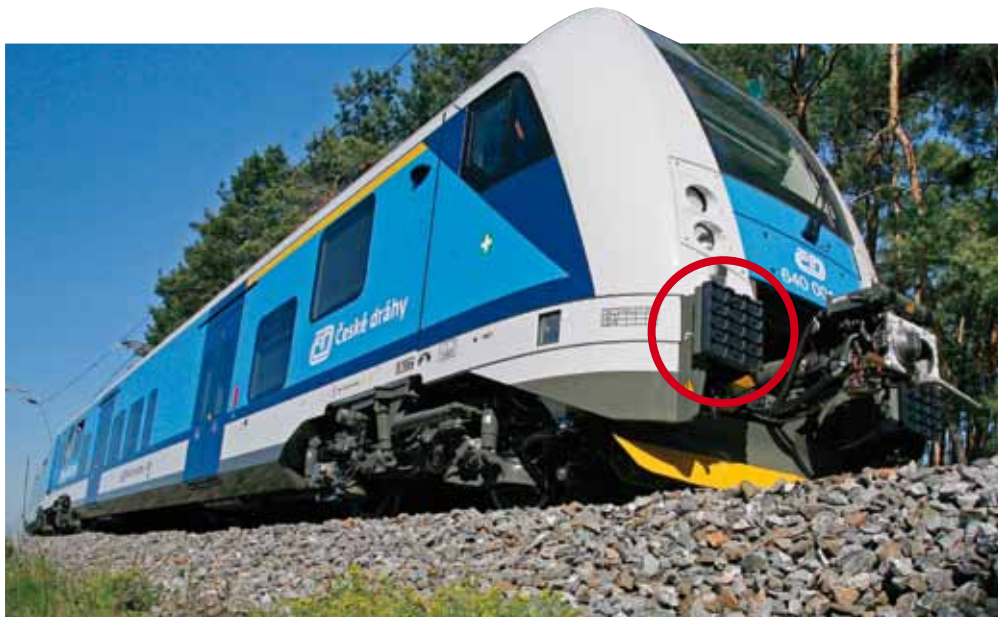
Řešení protišplhů u elektrické jednotky ČD typu RegioPanter (Škoda Transportation). Její kolizní odolnost je řádově vyšší, než byla u legendárních elektrických jednotek řady 451 z 60. let 20. století.
