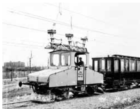
Tak vypadala zkušební lokomotiva na třífázový proud na snímku z roku 1899.
