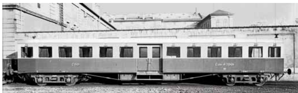
První nový přípojný vůz řady Calm pro motorové rychlíky Modré šipy z roku 1934 byl ještě ve smíšené stavbě s dřevěnou vozovou skříňí. Až pozdější série z let 1935–1936 byly celokovové.
