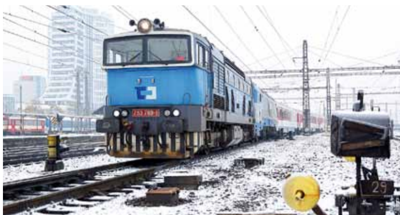
OLOMOUC. Břejlavec táhne vlak s elektrickou lokomotivou řady 380. Ve dnech ledovkové kalamity takový obrázek nebyl výjimkou. FOTO MICHAL MÁLEK
