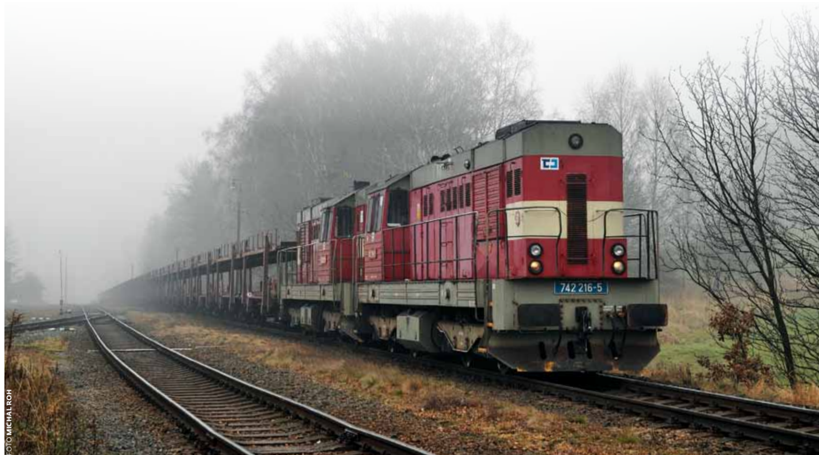
DVOJČATA. Pro přepravu nových automobilů do Polska jsou využívány čtyřnápravové patrové vozy vlastníka Škoda Auto řad Laaeks a Laaers.
