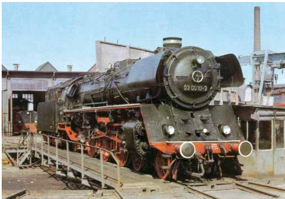
Parní lokomotiva řady 03.0010-3 z roku 1939 přestavěná v roce 1965 na vytápění olejem pro rychlost 140 km/h. Na snímku z května 1980 pózuje na jedné z točen depa Stralsund.
